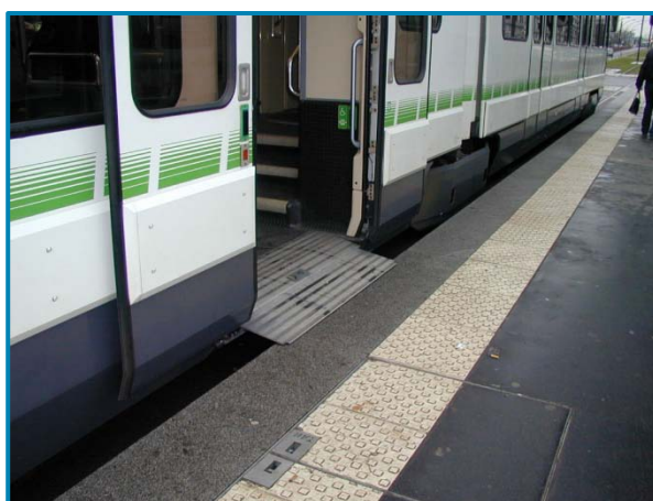
Figur 11: Bildene viser to løsninger for trinnfri innstigning for trikk i Nantes, Frankrike.
